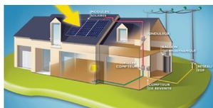
L'énergie photovoltaïque, c'est la conversion directe de la lumière du soleil en électricité. Sa production et les gains qui en découlent dépendent de plusieurs facteurs liés à l'environnement direct, au matériel utilisé et aussi au tarif de rachat de la production photovoltaïque.
